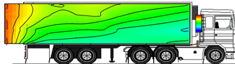
Warmtekaart na een deuropening van 10 minuten. Test uitgevoerd bij een Nederlandse voedseltransporteur
