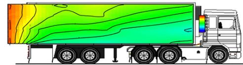
Wärmebild nach 10 Minuten mit geöffneten Laderaumtüren. Durchgeführt bei einem niederländischen Lebensmittel-Logistikunternehmen
